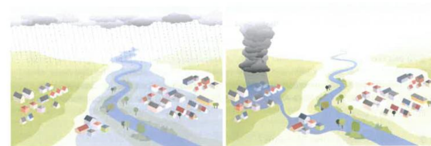
Abb. 3: Entstehung von fluvialen Hochwassern (links) und pluvialen Überflutungen (rechts). Fluviales Hochwasser entsteht durch länger anhaltenden Regen und geht von einem Gewässer aus; pluviale Überflutungen entstehen durch lokal begrenzten Starkregen direkt auf der Geländeoberfläche und können daher überall auftreten.
