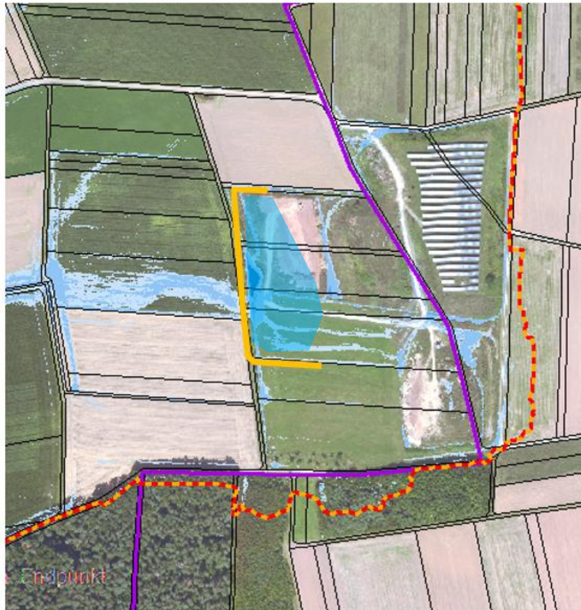
Abb. ___: Gefährdungssituation Erdaushub-/Bauschuttdeponie, Lastfall TN100
