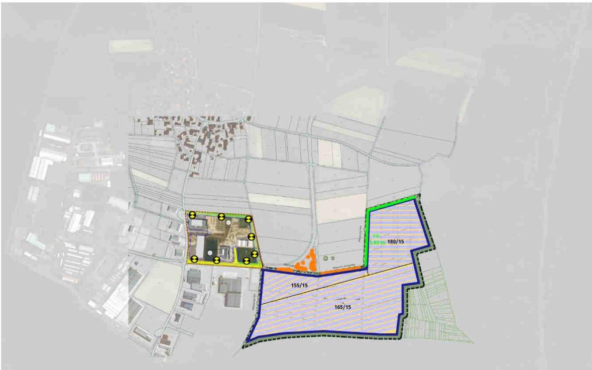
Im Hauptgutachten wurde bei der Bewertung möglicher Blendwirkungen an den Moduloberflächen der gegenständlichen Anlage davon ausgegangen, daß die möglichen Sichtachsen von der in diesem Gewerbegebiet vorhandenen Bebauung durch die Ausrichtung der Modulreihen, die vorgesehenen Sichtschutzanpflanzungen bzw. vorhandenen Bewuchs und teilweise auch durch die Verbauung unterbrochen werden.
