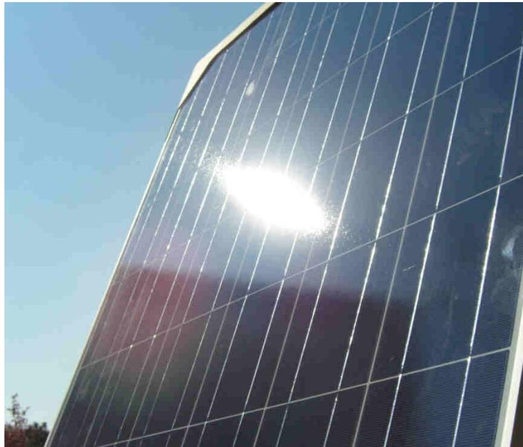
Bündelaufweitung beim Sonnentest eines polykristallinen Moduls,
